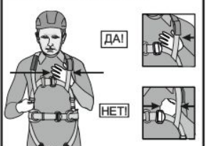
Рис. 12. Способ организации удерживающей системы
