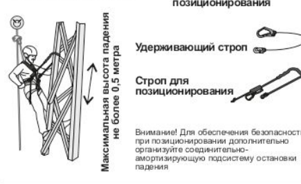
Рис. 13. Позиционирование в рабочем положении
