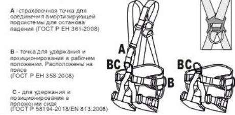
Рис. 2. Типы крепежных точек
