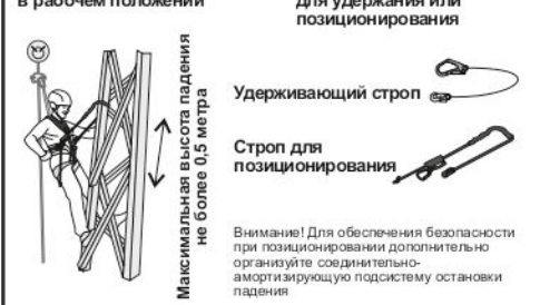
Рис. 12. Позиционирование в рабочем положении
