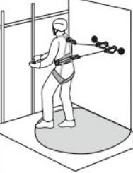
Рис. 14. Позиционирование в рабочем положении
