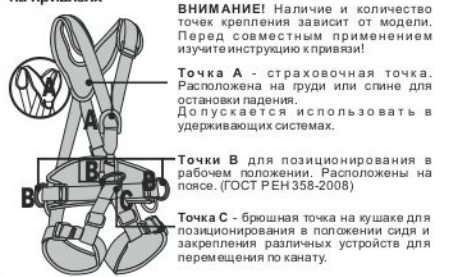
Рис. 3. Расположение и назначение крепежных точек на привязях
