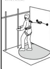
Рис. 12. Способ организации удерживающей системы
